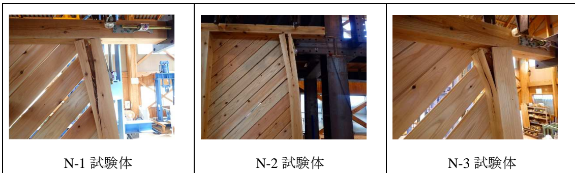
写真 2.2.7 各試験体の最終加力試験途中での破壊性状
